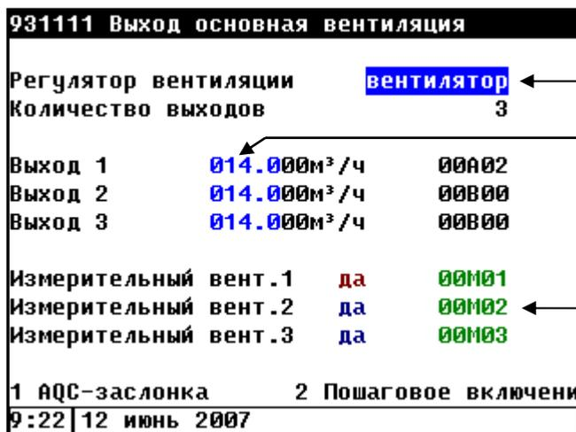
Пошаговое включение и AQC-заслонка недоступны, когда "Регулятор вентиляции" установлен в значение "заслонка".
