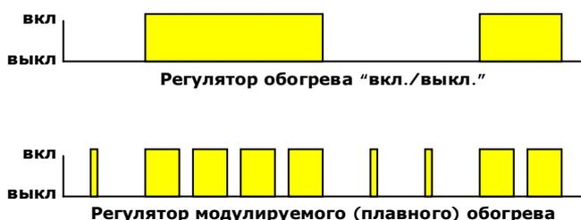
Регулятор модулируемого обогрева предпочтительнее, так как препятствует отставанию обогрева и тому, чтобы температура в помещении становилась слишком высокой, в результате чего регулятору вентиляции придется рассеивать излишнее тепло.
