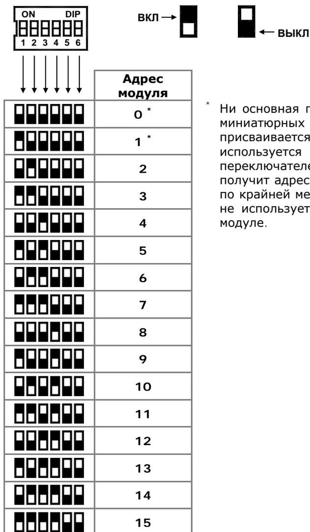
\* Ни основная плата PL-9200, ни внутренний модуль не имеют миниатюрных переключателей типа DIP. Адрес модуля 0 присваивается основной плате автоматически. Если используется внутренний модуль (без миниатюрных переключателей типа DIP), тогда плата автоматически получит адрес 1 и адрес внешнего модуля должен начинаться по крайней мере с адреса 2. Если никакой внутренний модуль не используется, адрес 1 может быть установлен на другом модуле.
