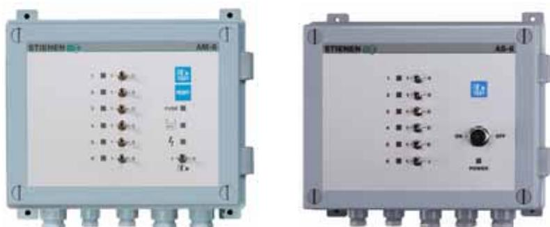
Только AM-6 имеет функцию памяти, которая обеспечивает, чтобы СИД соответствующего контактного входа продолжал светиться даже в том случае, если причина аварии была исправлена автоматически, до тех пор, пока панель аварийной сигнализации не будет сброшена вручную. Это облегчает поиск отказов, которые происходят только время от времени.
