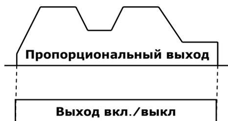
Вы задаете выход для таймера освещения на этом экране. Если вы введете "регулируемый" после таймера освещения, регулятор климата будет предполагать, что вы хотите применить регулирование освещения.
