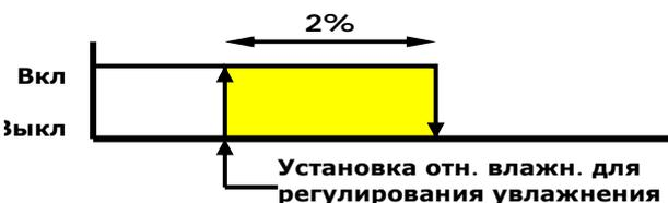
компьютер для птицеводства может контролировать относительную влажность в помещениях, в которых есть туманообразующая система. Если измеренная относительная влажность падает ниже предварительно установленного значения, будет включена туманообразующая система. Если обогрев включен, тогда контроль увлажнения будет выключен.
